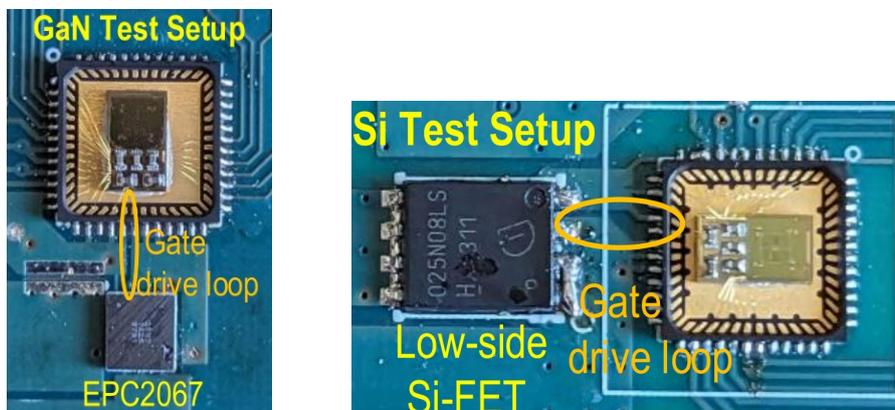
[그림 1] 본 논문에서는 GaN & Si-FET power device들을 사용하여 제안된 게이트 드라이버의 성능을 측정하였다.
